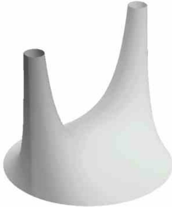
Abb. 2: SHERCLIFF' sche Wertigkeiten W_S(x,y) von 0,5 bis 2 dargestellt über dem Einheitskreis Fig. 2: Valences W_S(x,y) from 0,5 to 2 after SHERCLIFF
