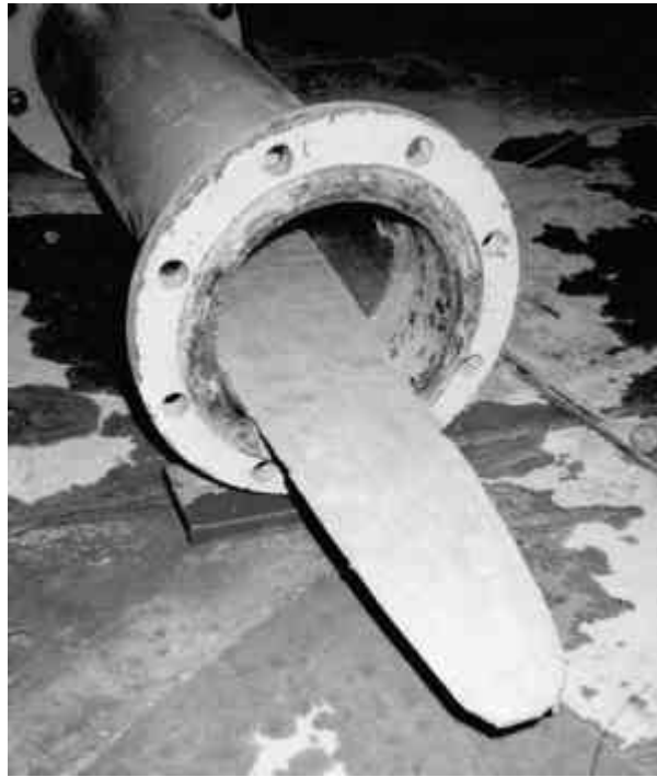
Abb. 5: Laborleitung mit Betonformteil zur Simulation der Sedimentation
